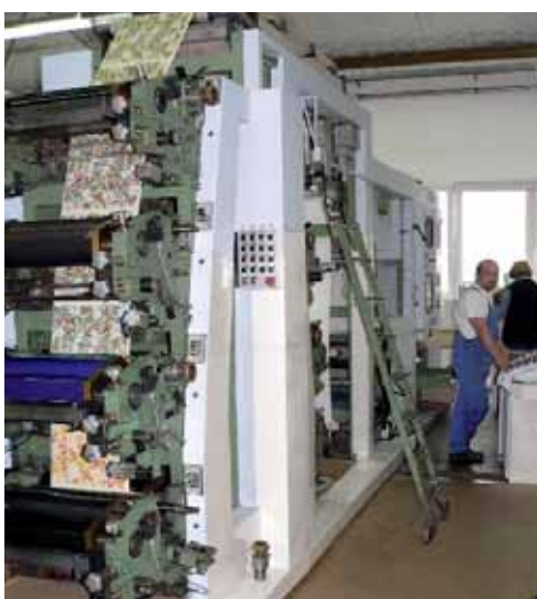
„Perfekter Druck“ mit modernen Flexo-Druckmaschinen: Gedruckt wird im Rollenflexodruck auf insgesamt 11 Druckmaschinen mit je 8 Farbwerken.
